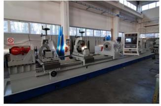
镗床带有控制轴,用于加工第二个孔时工件的精确定位。
