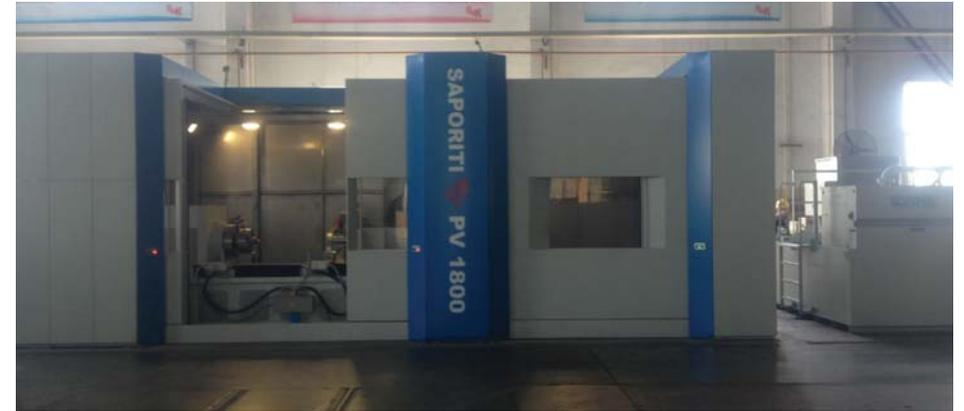
新一代的萨伯利蒂球阀磨床专门被设计用于硬密封以及硬质涂层球体的精密磨削。萨伯利蒂 SAPORITI PV 系列球阀磨床可加工通径**1"-64"** 不同尺寸的球体，所有的设备都是萨伯利蒂公司长期经验的累积和最新技术运用的成果，保证为我们的客户提供可靠和高精度的设备。即使是对圆度要求极高的客户，SAPORITI PV 系列球阀磨床仍能加工出远超出其要求的产品。
