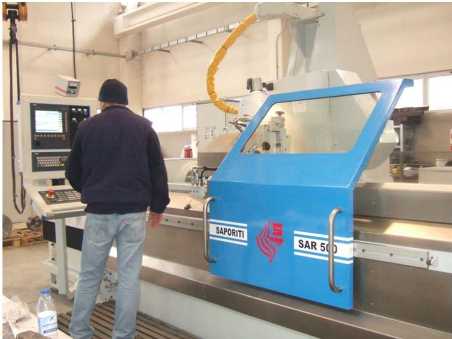
Die neue CNC-gesteuerte Fräsmaschine **SAPORITI SAR** ist eine spezielle Maschine für die Herstellung von Pumpen- und Verdichterschnecken mit normalen oder profilierten Scheibenfräsern.
