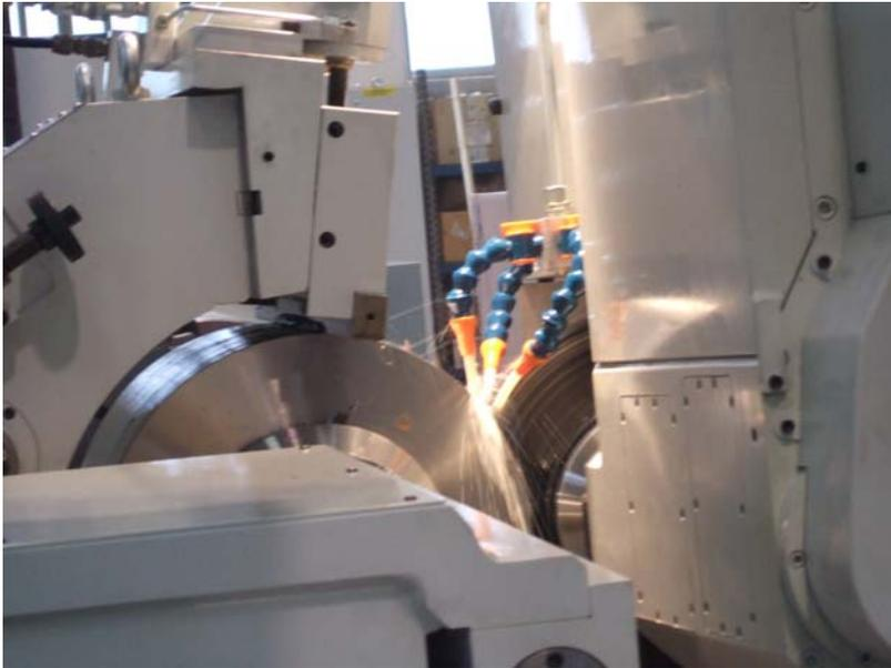
Die CNC-Steuerung Siemens 840D gestattet eine einfache Programmierung der Schneckenbearbeitung auch durch "kundenfreundliche" Programmiermasken, die spezifisch von Saporiti entwickelt und ausgeführt werden.
